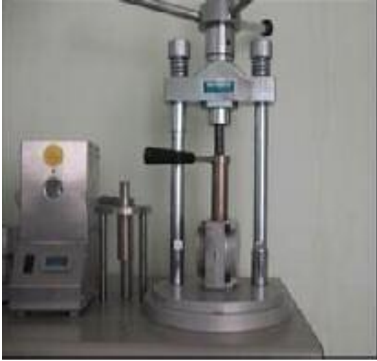
Resim 4: Valplast enjeksiyon sistemi
