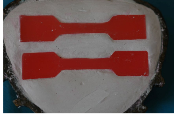
Resim 2. 6x6x3 cm boyutlarındaki boşluklara yerleştirilen yumuşak astar.
