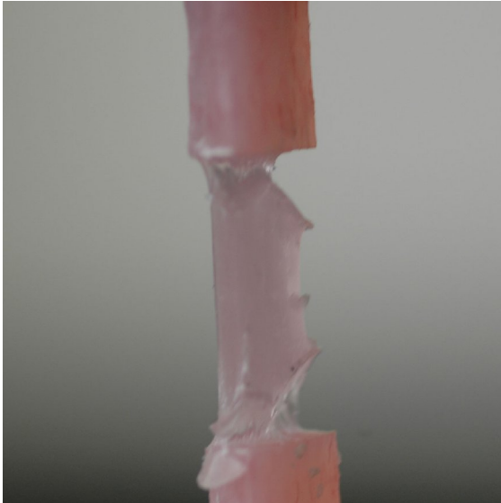
Resim 3. Otopolimerizan yumuşak astar materyalinde görülen adeziv başarısızlık.
